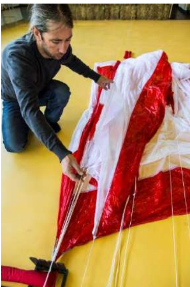
Fig. 62 Suivez le bord de fuite du second panneau
