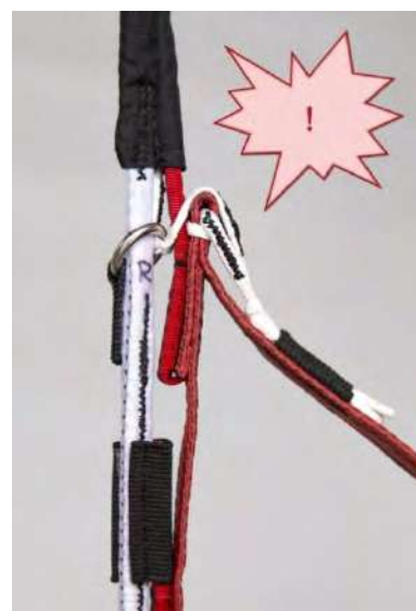
Fig. 16 portion rigide hors de l'anneau métallique!
