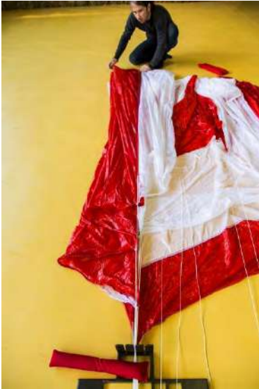
Fig. 74 Suspente dans le séparateur
