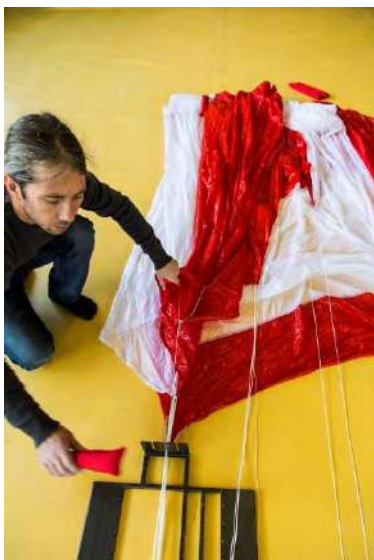
Fig. 71 Suspente #4 dans le séparateur
