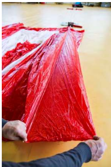
Fig. 72 Posez le panneau #4 à l'extérieur et pliez le en 2
