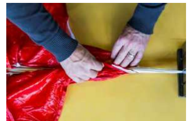
Fig. 88-89 Enroulez les tissus autour des suspentes
