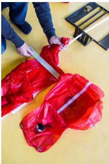
Fig. 116 Pliez à la taille du pod
