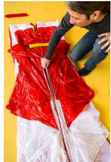
Fig. 85 Vérifiez que les suspentes soient bien claires ...
